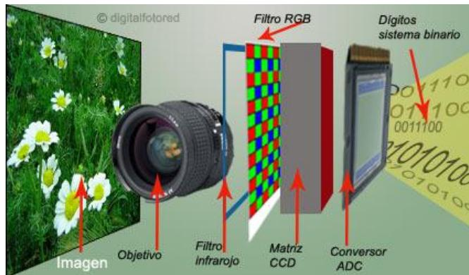
La trayectoria que sigue la cámara para formar la imagen digital es la siguiente forma: La luz que detecta el objetivo de la cámara llega hasta el sensor de imagen, denominado CCD formado por multitudes de receptores fotosensibles denominados "fotodiodos".
